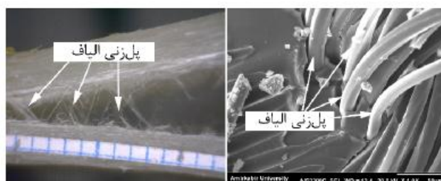
شکل 4: تصاویر میکروسکوپیک و ماکروسکوپیک از پدیده پل زنی الیاف در ناحیه پشت نوک جدایش بین لایه‌ای در نمونه U
