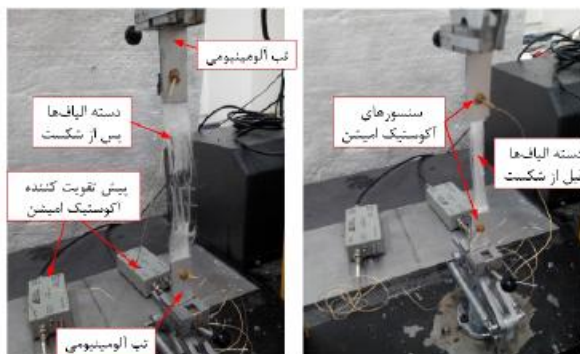
شکل 7: آزمایش گشش الیاف و ثبت سیگنال‌های آکوستیک امیشن آن
