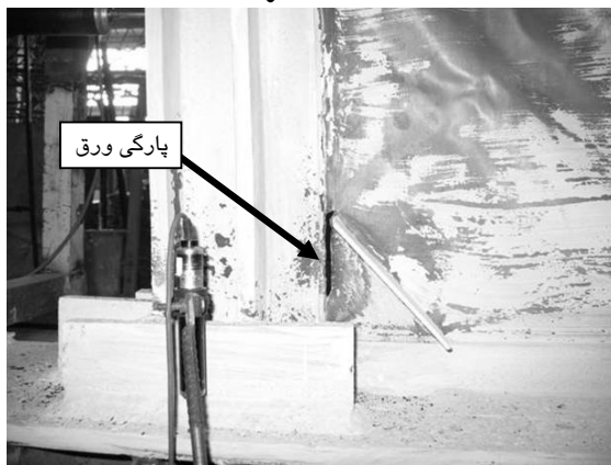
شکل (۱۰): جداسدگی ورق از نبشی در تغییر مکان \delta_{y1} ۳۰/۱۸ در سخت کننده شماره ۲
