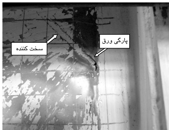
شکل (۸): جداشدگی ورق از لبه سخت کننده در تغییر مکان \delta_{y1} ۱۵/۳۵ در سخت کننده شماره ۴
