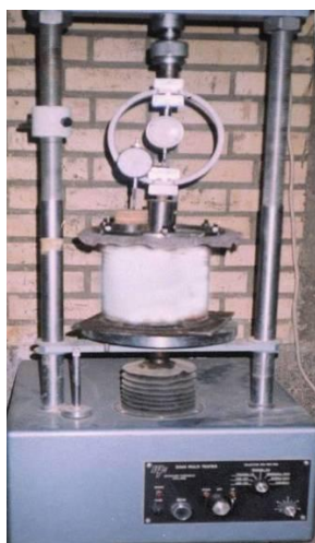
شکل (۳): قالب به کار رفته در تعیین مقاومت سوراخ‌شدگی ژئوتکستایل
