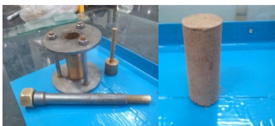
شکل (۱): قالب تراکم هاروارد و نمونه استوانه‌ای ساخته شده توسط این وسیله
