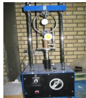
شکل (۲): دستگاه آزمایش مقاومت فشاری محصور نشده مورد استفاده
