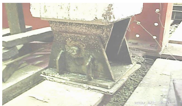
شکل (۲) - اتصال مفصلی ابتدا و انتهای ستون
