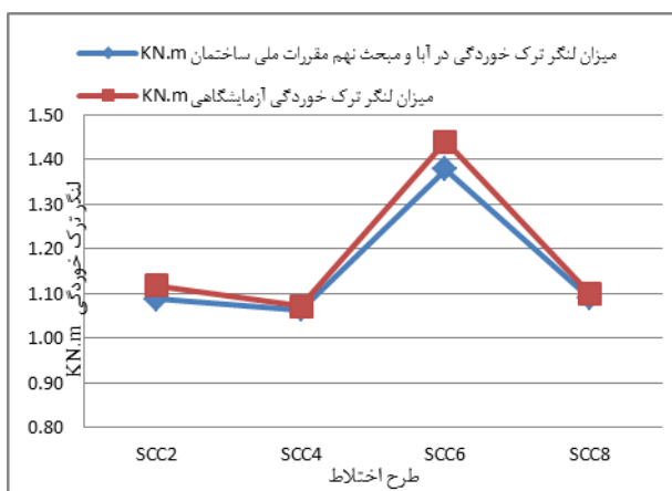
شکل (۱۳): مقایسه لنگر ترک خوردگی آزمایشگاهی و لنگر به دست آمده از روابط آبا و مبحث نهم مقررات ملی ایران، آب به سیمان ۰/۳۵، حاوی میکروسیلیس
