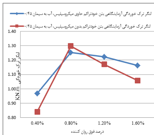
شکل (۱۱): تأثیر میکروسیلیس بر مقاومت پیچشی بتن خودتراکم با نسبت آب به سیمان ۰/۴۵
