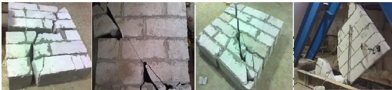
شکل (۶): نحوه‌ی شکست در نمونه دیوارهای مورد آزمایش کشش قطری
