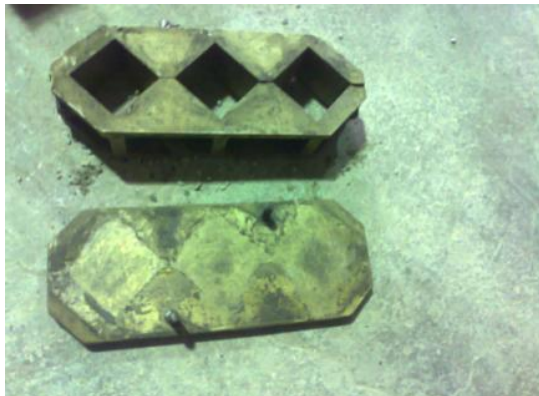
شکل (۲): قالب ویژه ی مقاومت فشاری ملات
