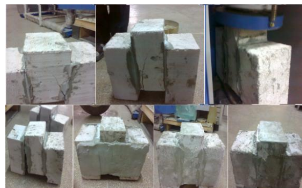
شکل (۳): نمونه‌ها و آزمایش‌های انجام شده مقاومت برشی ملات
