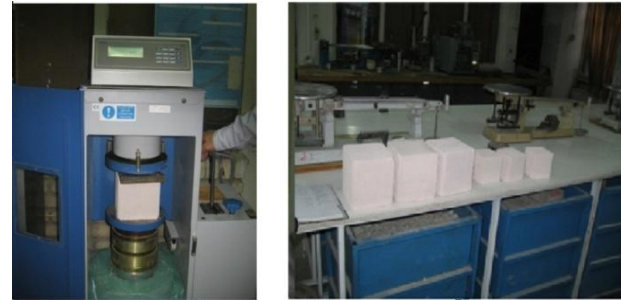
شکل (۱): نمونه‌ها و آزمایش مقاومت فشاری AAC
