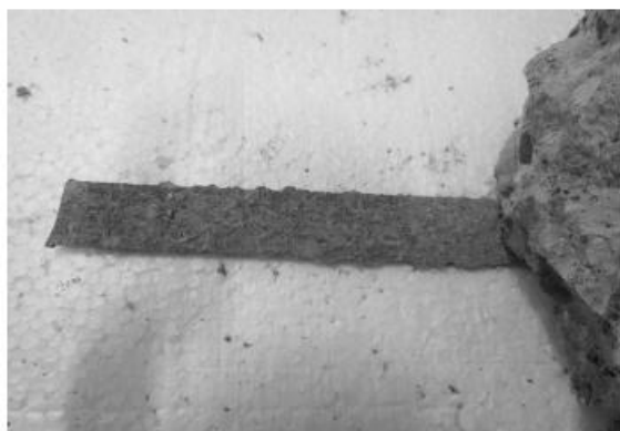
شکل ۲۳: سطح گسیختگی پس از جداشدگی در تیرهای سری D در دمای 20^{\circ}\text{C}
