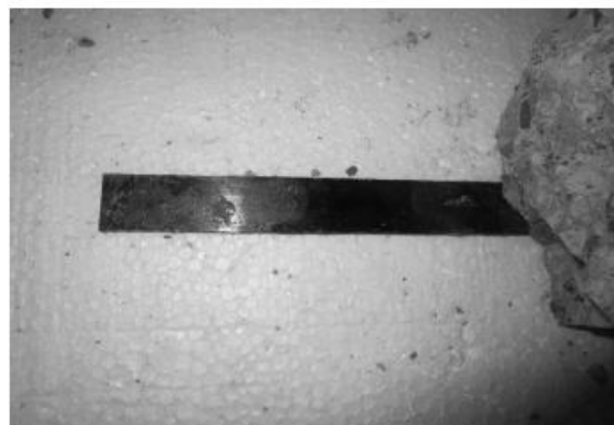
شکل ۲۴: سطح گسیختگی پس از جدایشگی در تیرهای سری A در دمای 50^{\circ}\text{C}
