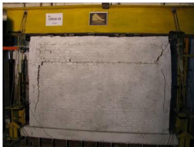
شکل ۷: تصویر نمونه CMSW-04 پس از گسترش ترک‌ها
