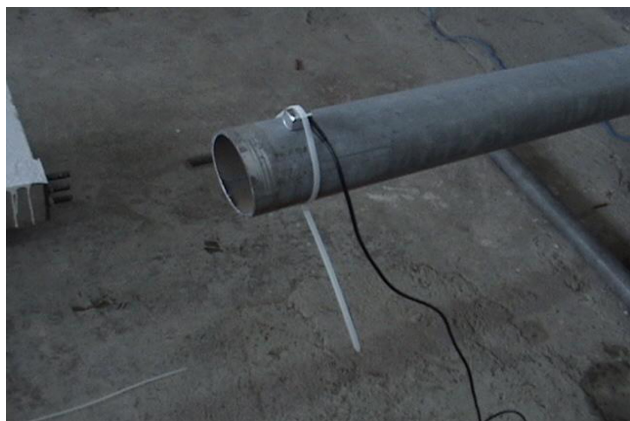
شکل ۳: اتصال شتابسنج به انتهای آزاد لوله
