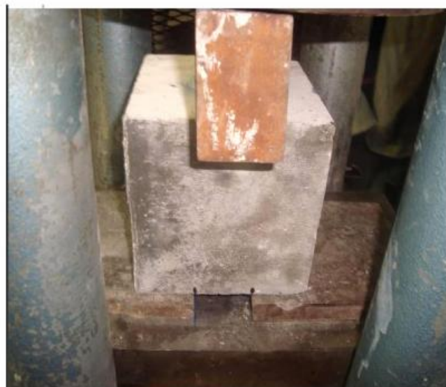
شکل ۱۸: نحوه انجام آزمایش برش مستقیم
