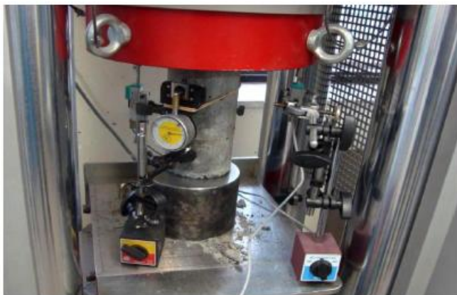
شکل ۱۹: آزمایش تعیین رفتار تنش-کرنش بتن
