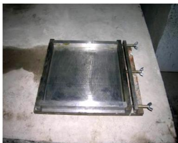
شکل ۳: قالب فولادی مورد استفاده برای ساخت پانل بتن الیافی
