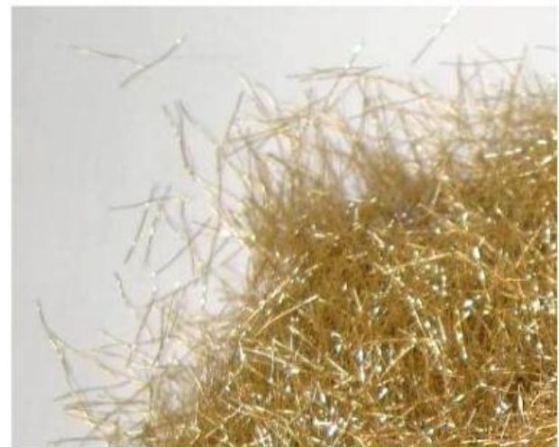
شکل ۱۶: ماکرو الیاف تولید شرکت صنایع مفتولی زنجان (بالا) و میکرو الیاف تولید شرکت STRATEC آلمان (پایین)
