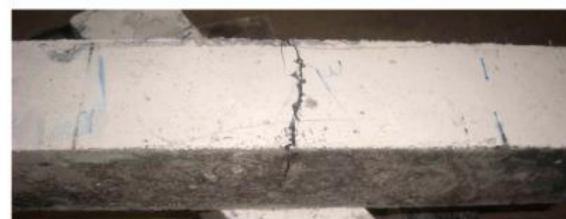
شکل ۱۷: حالت شکست خمشی؛ (بالا) نمونه مسلح به ماکرو الیاف فولادی و (پایین) نمونه مسلح به میکرو الیاف فولادی
