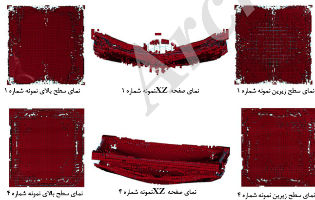
شکل ۷: گسیختگی ایجاد شده تحت انفجار با فاصله مقیاسی نزدیک ( 0.56 \text{ m/kg}^{1/3} )
