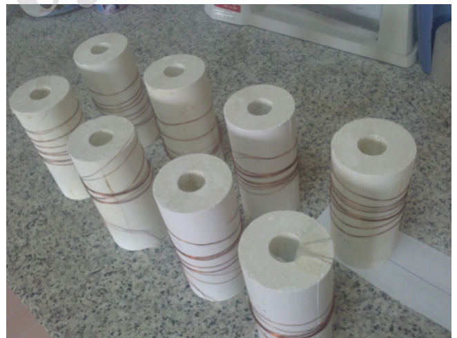
شکل ۵: نمایی از نمونه های استوانه ای توخالی جدار ضخیم گچی تهیه شده برای آزمایش
