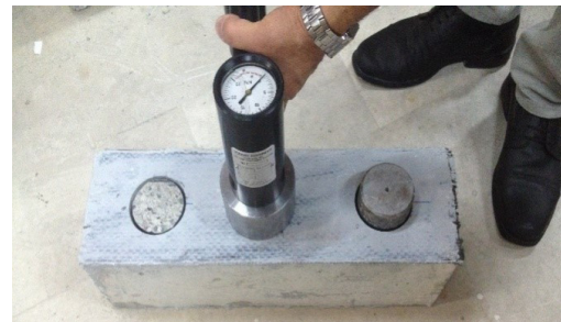
شکل ۵: آزمایش مقاومت چسبندگی بر روی ورق‌های کامپوزیتی
