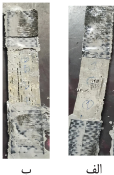
شکل ۴: (الف) پاره‌شدگی ورق شیشه/اپوکسی از ناحیه الیاف بعد از قرارگیری در محیط دریایی (ب) جدا شدن الیاف از چسب در ورق‌های کربن/اپوکسی حین تست کشش بعد از قرارگیری در محیط دریایی
