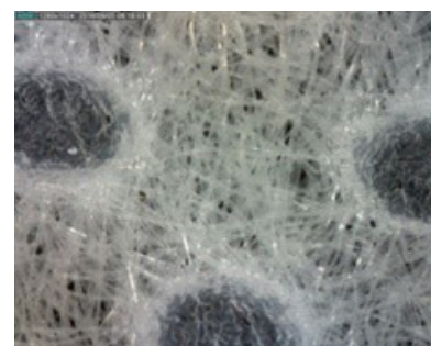
شکل ۳: تصویر میکروسکوپی پارچه ۵۰ گرم بر متر مربع Fig. 3. Microscope images of 50 g/m² fabric
