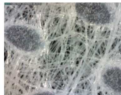
شکل ۲: تصویر میکروسکوپی پارچه ۴۰ گرم بر متر مربع Fig. 2. Microscope images of 40 g/m² fabric
