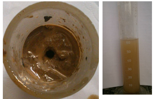
شکل ۴: کیفیت آب خروجی از نمونه و اندازه قطر سوراخ در پایان آزمایش با ۱٪ وزنی نفت و آغشته به محلول ۱۲٪ هگزامتافسفات سدیم
