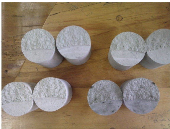
شکل ۵: نمونه‌های شکست شده پس از انجام آزمایش خمش سه نقطه‌ای
