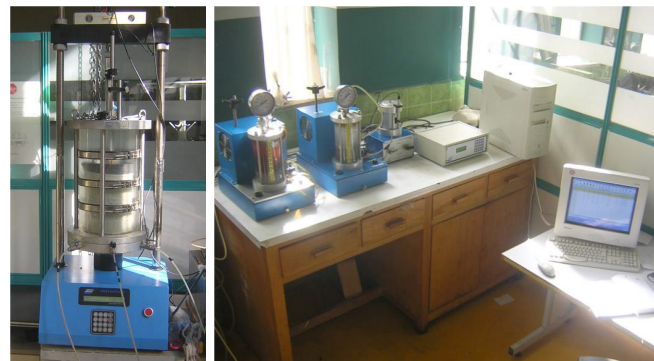
شکل ۴: اجزای دستگاه سه محوری استفاده شده در این تحقیق
