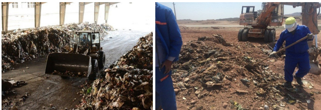
شکل ۲: (راست) موقعیت دیو و محل تهیه نمونه های زباله تازه (چپ) حفاری در محل مرکز دفن آزمایشی برای تهیه نمونه سالخورده
