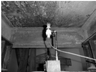
شکل ۳: نحوه قرارگیری دستگاه تغییر مکان‌سنج زیر نمونه
