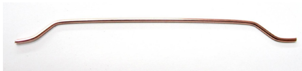
شکل ۸: الیاف فولادی قلابدار Fig. 8. Hooked Steel Fibers
