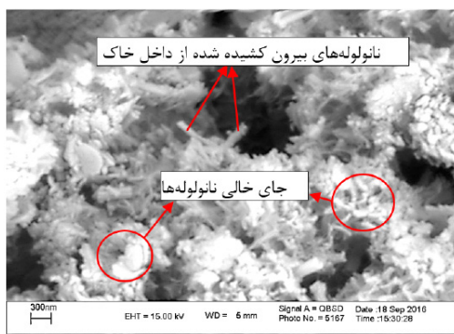
شکل ۱۷: تصویر SEM از خاک ماسه‌ای تثبیت شده با سیمان و نانولوله به مقدار ۰/۱۲۵ درصد وزنی سیمان
