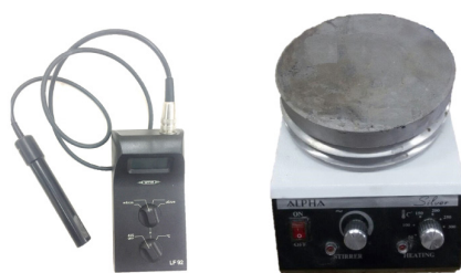
شکل ۳: همزن مغناطیسی و دستگاه رسانایی سنج مورد استفاده در آزمایش تعیین خاصیت پوزولانی مواد
