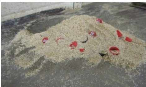
شکل ۴: آماده سازی نمونه مسلح شده با ترکیب تصادفی
