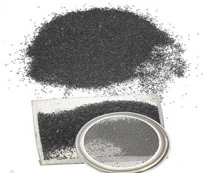
شکل ۴: الک کردن خرده لاستیک‌ها
