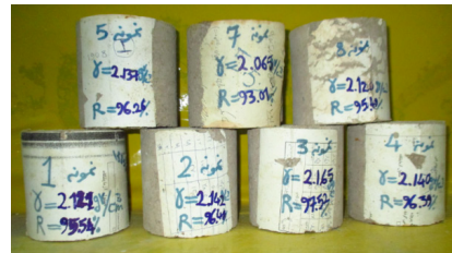
شکل ۸: نمونه خاک‌های متراکم شده برای آزمایش چکش ضربه Fig. 8. Sample Soil Samples for Impact Hammer Test
