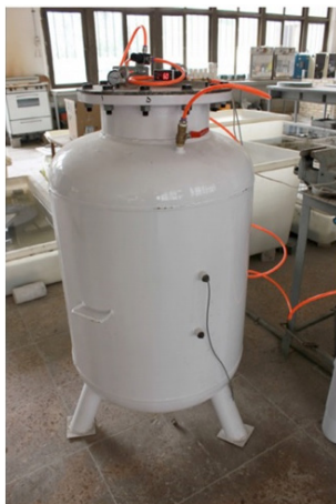
شکل ۴: محفظه‌ی کربناسیون استفاده شده در آزمایش تعیین عمق کربناسیون
