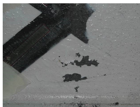
شکل ۵: ایجاد مفصل پلاستیک در درون چشمه اتصال نمونه SC1 در دررفت ۲٪
