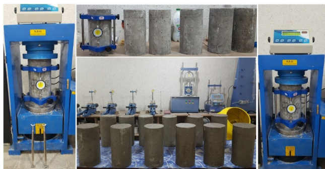
شکل ۸: روند انجام آزمایش تعیین ضریب ارتجاعی
