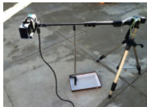
شکل ۲. دستگاه اولیه مورد استفاده برای داده‌برداری، داده‌برداری با سه‌پایه دوربین از سطح روسازی
