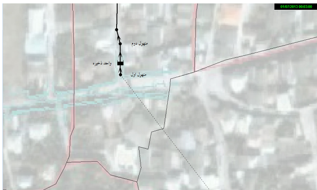
شکل ۵: موقعیت واحد ذخیره‌ی سری پیشنهادی در محل گره بحرانی Suggested location of Series detention tank unit in critical node place
