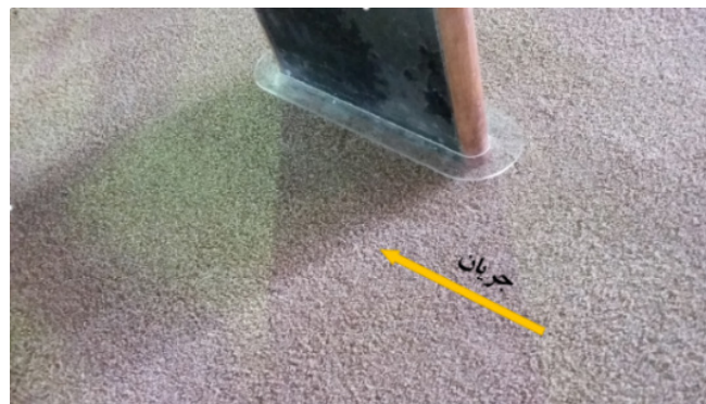
شکل ۴. نمایی از پایه و طوقه نصب شده روی آن A view of the pier and collar placed on it
