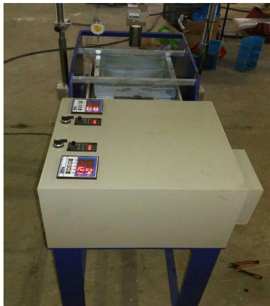
شکل ۱۷. دستگاه برش مستقیم بزرگ مقیاس Large-scale direct shear
