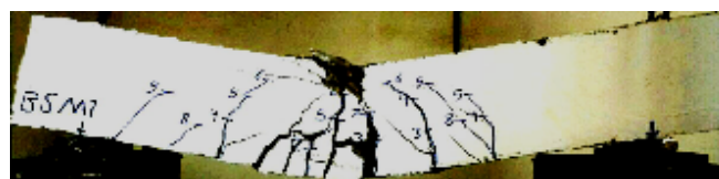
شکل ۹. وضعیت نمونه‌ی BSM1 پس از پایان بارگذاری Fig. 9. Crack propagation in specimen BSM1
