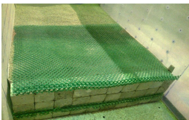
نحوه قرارگیری ردیف برش خورده در داخل انتهای جلویی لایه تسلیح
