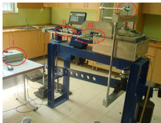
شکل ۳. تصویری از دستگاه برش مستقیم بزرگ مقیاس مورد استفاده و متعلقات آن، (I. دستگاه دیتالاگر جهت ثبت داده‌ها، II. نیروسنج، III. کرنش سنج افقی، IV. کرنش سنج قائم)
