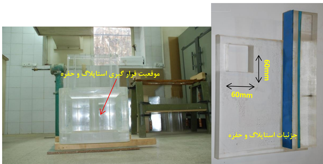
شکل ۳. سازه مجزای تحتانی سد گتوند (مقیاس ۱/۴۰) و جزئیات استاپلاگ مربوطه Fig. 3. Structure of deep conduit of Gotvand dam (scale 1:40) and relevant stoplog details
