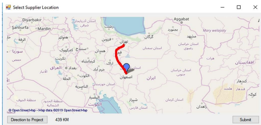
شکل ۸. نمای کلی روند تعیین فاصله حمل مصالح در ابزار توسعه یافته
