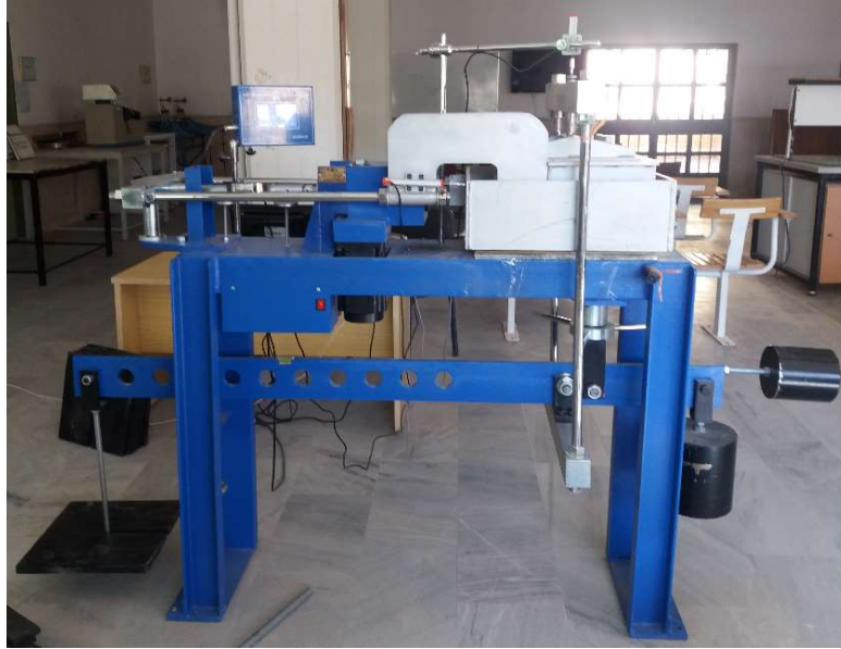
شکل ۴: دستگاه برش مستقیم بزرگ مقیاس Fig.3. Large scale direct shear machine
