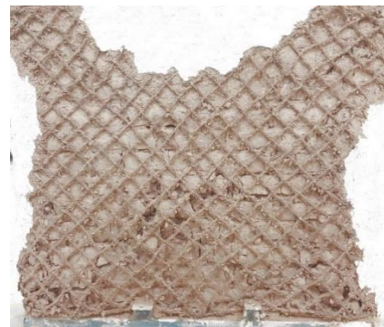
شکل ۱۰. مود شکست خردشدگی پاشنه ناشی از حرکت گهواره ای نمونه W6
