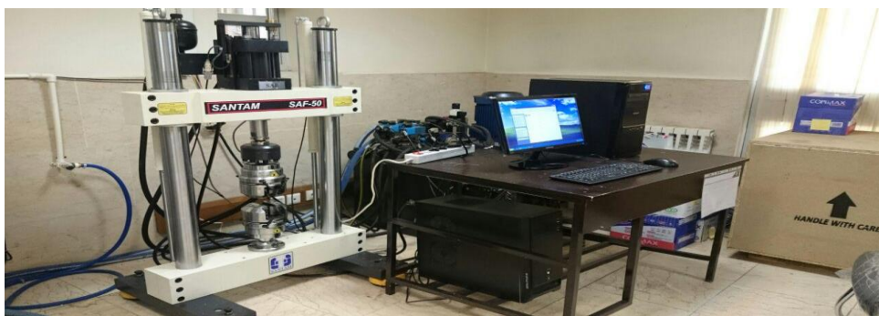
شکل ۶. دستگاه تست خستگی
