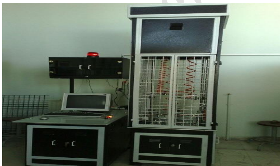
شکل ۵. دستگاه تست ضربه
