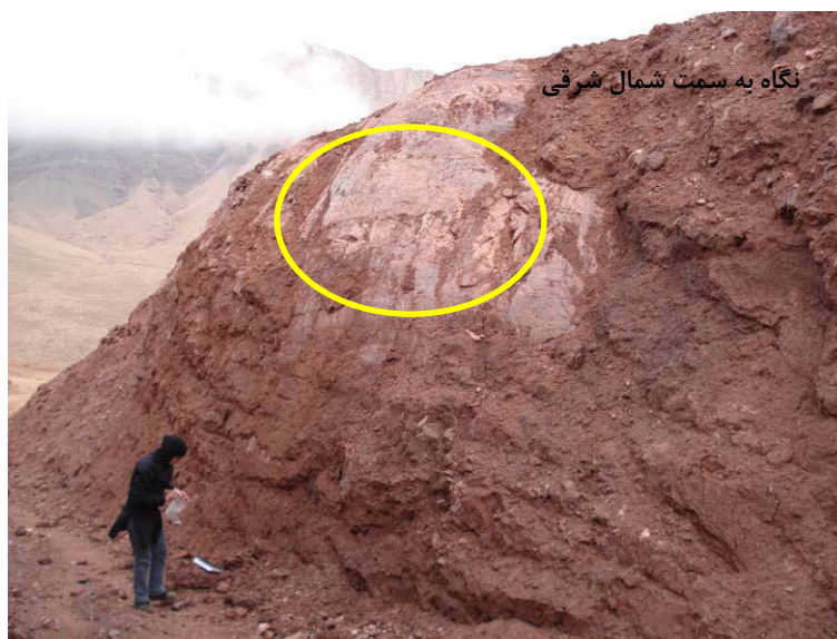
شکل ۴: آینه گسل در داخل ترانشه زده شده در داخل معدن تپه سرخ
