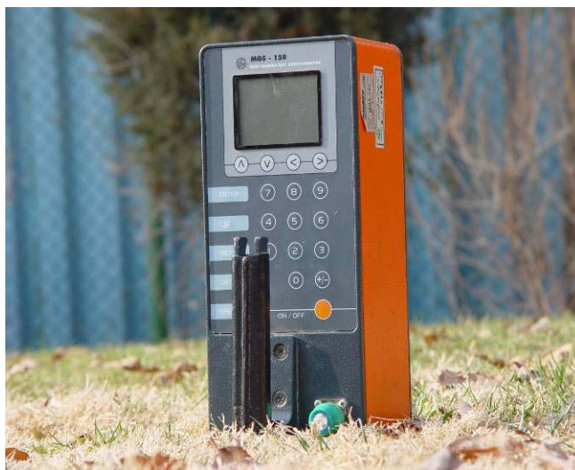
شکل ۶: دستگاه اسپکترومتری مدل MGS 150 جهت اندازه گیری عناصر پرتوزا در کنترل زمینی
