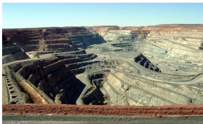
تصویر ۱: عملیات استخراجی به روش پلکانی در معدن سرب و روی انگوران قبل از ریزش معدن
