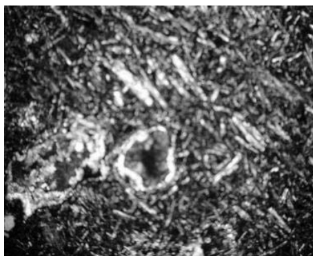
شکل ۵: الیوین بازالت با بافت گلمروپرفیریک و فنوکریست‌های پلاژیوکلاز و الیوین با بافت اسکلتی بزرگنمایی ۴۰* XPL
