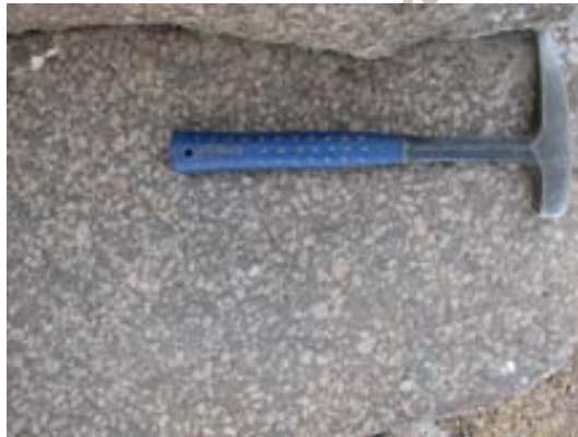
شکل ۲: بافت مگاپورفیری در گدازه آندزیتی
