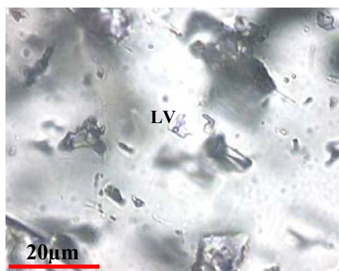
شکل ۱۶: انکلوزیون دو فازی اولیه (با نسبت حجمی L > V ) و با شکل نامنظم در نمونه MC-6
