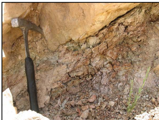
شکل ۶: شیبست های میلونیتی در امتداد گسله های فرعی - سینه کار پائینی معدن
