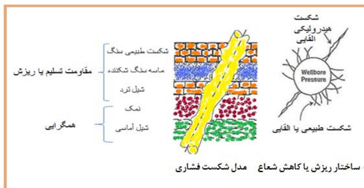
شکل ۱: ناپایداری معمول مشاهده شده در چاه نفت (Tara and Mody, 2002)
