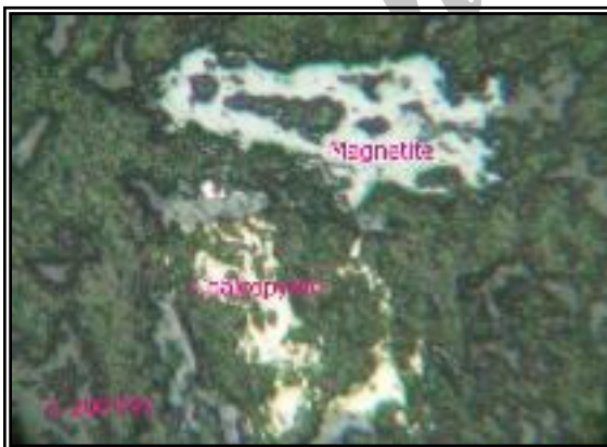
شکل ۱۱: مقاطع صیقلی رگه‌های سیلیسی کانه‌دار
