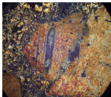
شکل ۵: نمایی از بافت تیغه ای (لاملاز) در کلینوپیروکسن. احتمالاً تیغه‌های جدایشی اورتوپیروکسن می‌باشند.
