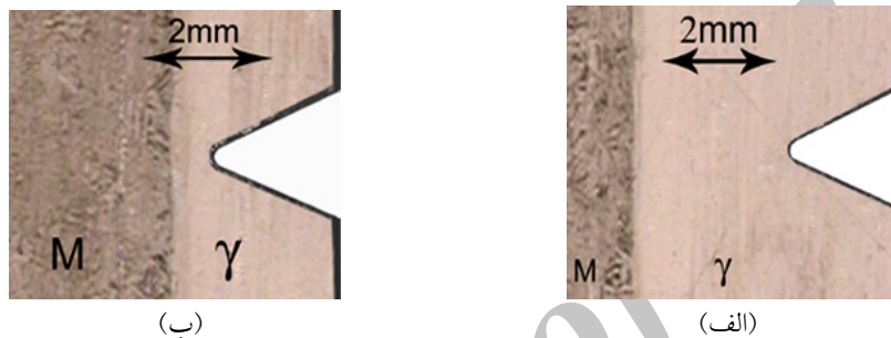
شکل ۳- فاصله نوک شیار از لایه مارتنزیتی در کامپوزیت \gamma M\gamma : نزدیک شدن شیار به لایه مارتنزیتی کاهش مقاومت به ضربه کامپوزیت را به همراه دارد.
